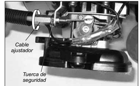
Gire el cable ajustador hacia dentro o fuera como sea requerido
